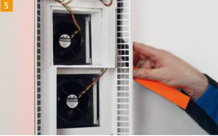
Kleben Sie den zweiten Verschlussstreifen von außen auf den raumseitigen Luftdurchlass (siehe Kap. **Übersicht AIRUNIT GEMINI**, Buchstabe H), um die Innenblende mechanisch zu verschließen.
