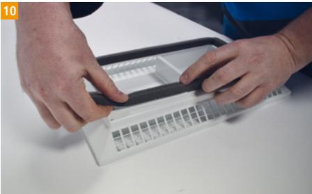
Kleben Sie das mitgelieferte Dichtband umlaufend auf die Rückseite der Außenwandkonsole.
