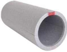
Die wärmegeädämte AIRUNIT Wanddurchführung rund Neopor® kann nach erfolgter Montage mühelos mit einem Messer gekürzt werden. Das integrierte Gefälle ermöglicht den Abfluss von Kondensat selbst bei waagerechtem Einbau. Die Wanddurchführung rund ist in den Längen 495 oder 1000 mm verfügbar.
