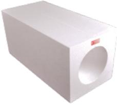
Die eckige AIRUNIT Wanddurchführung besteht zur Vermeidung von Kältebrücken aus dem Wärmedämmstoff EPS. Das integrierte Gefälle zur Ableitung von Kondensat sowie das einfache Anpassen an die Wandstärke erleichtern die Installation. Die Montage während der Rohbauphase erfolgt durch Einmauern, alternativ durch eine Öffnung (mind. 220 x 220 mm). Die Wanddurchführung eckig ist in den Längen 500 oder 1000 mm verfügbar.
